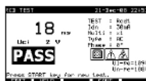
Beispiel für Messergebnisse der RCD-Auslösezeit
