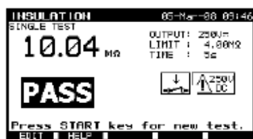
Voorbeelden van de resultaten van de meting van de isolati weerstand
