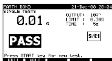
Voorbeelden van de resultaten van de PE-beschermingsleiding Links: resultaat voor een meting met positieve uitslag Rechts: resultaat voor een meting met negatieve uitslag
