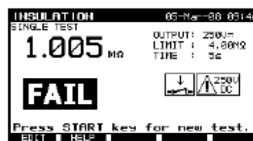
Voorbeelden van de resultaten van de meting van de isolati weerstand
