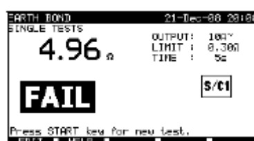
Voorbeelden van de resultaten van de PE-beschermingsleiding Links: resultaat voor een meting met positieve uitslag Rechts: resultaat voor een meting met negatieve uitslag
